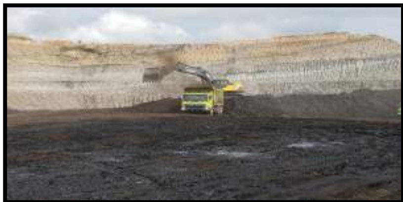
Gambar 4.5 Kegiatan Pemuatan Batubara ke Dump Truck
