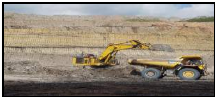
Gambar 4.3 Kegiatan Pengupasan Tanah Penutup
